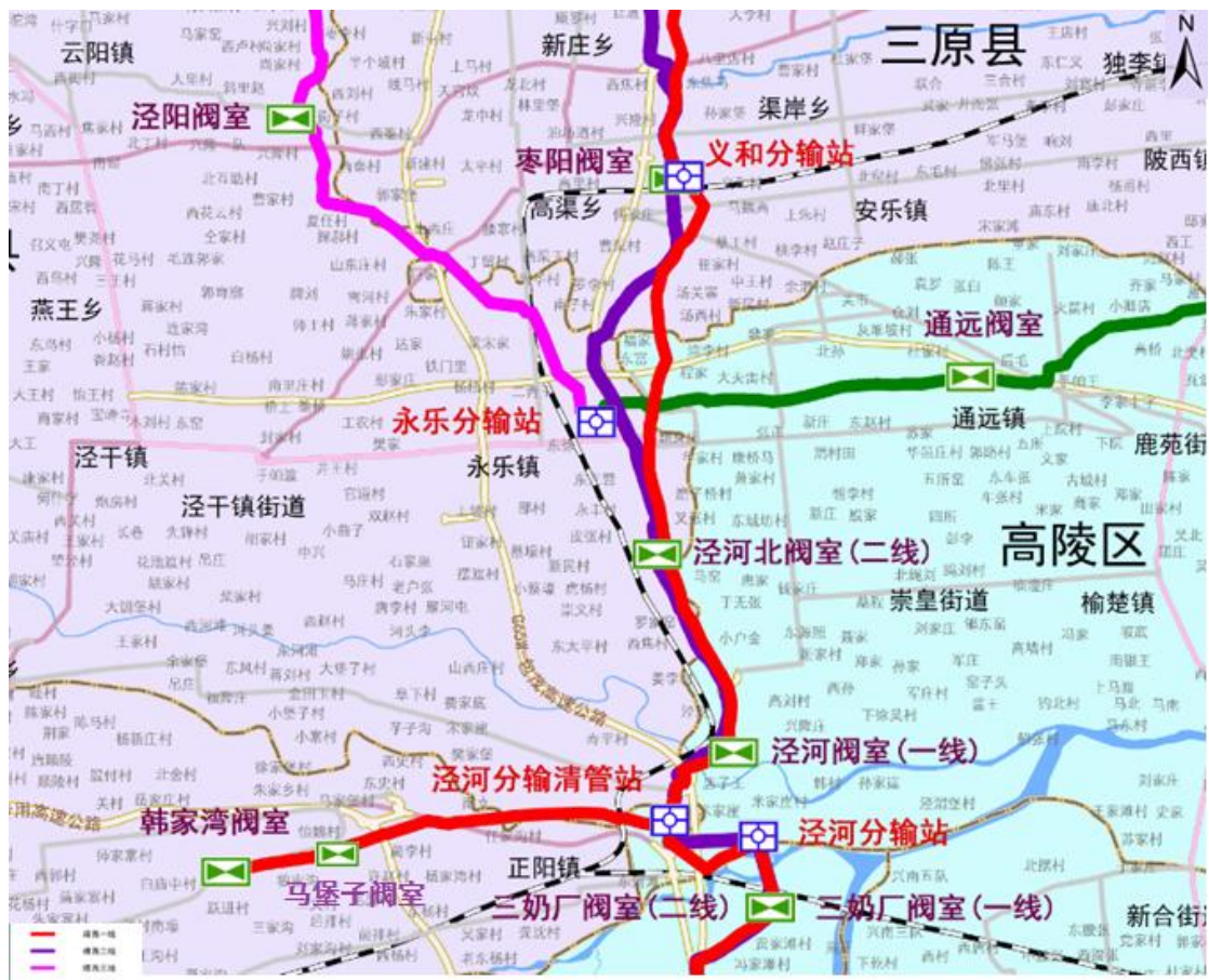
图 3.1-1 靖西一线、靖西二线、靖西三线（西咸新区）段天然气管道走向、阀室分布图
